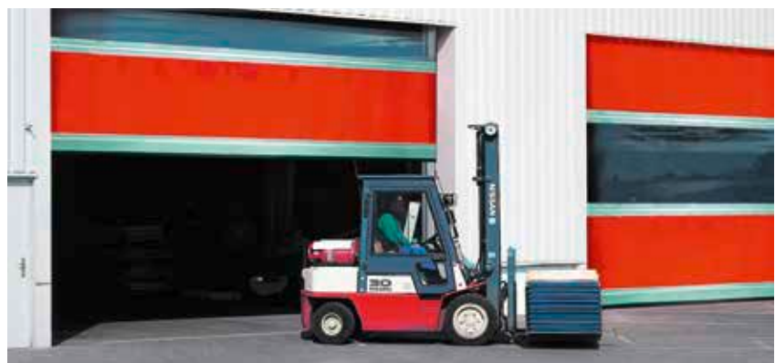
Schnelllauf-Folientore schützen Personen und Material durch das integrierte Federkraft-Crash-Schutzsystem
